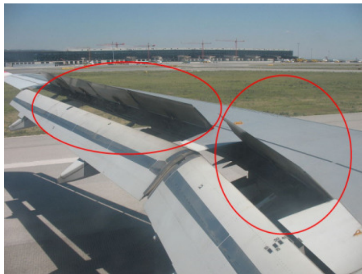
Rem Udara (Air Brake Spoiler) pada pesawat jet dengan cara membuat Drag.
